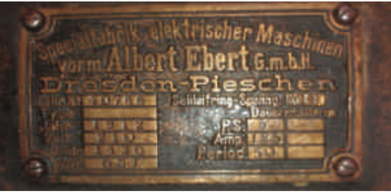
Abb. Typenschild des E-Motors (Foto W. Wünschmann).
